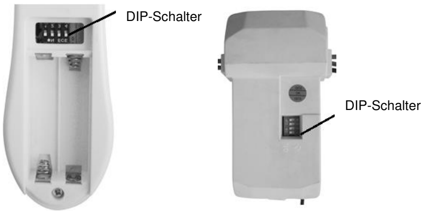
Abb. 11 Batteriefach der Fernbedienung
